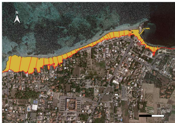
Figura 12. Visualizzazione in Quantum GIS dei transetti generati, necessari per stimare l'arretramento della linea di costa nell'area in Figura 10 e 11.
