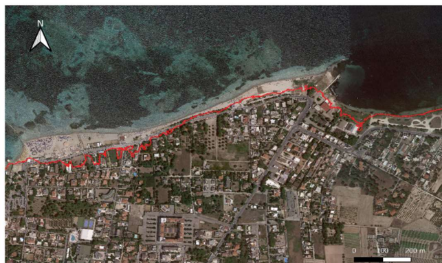
Figura 111. Visualizzazione in Quantum GIS della linea di costa futura estratta dal poligono sommerso in Figura 9.
