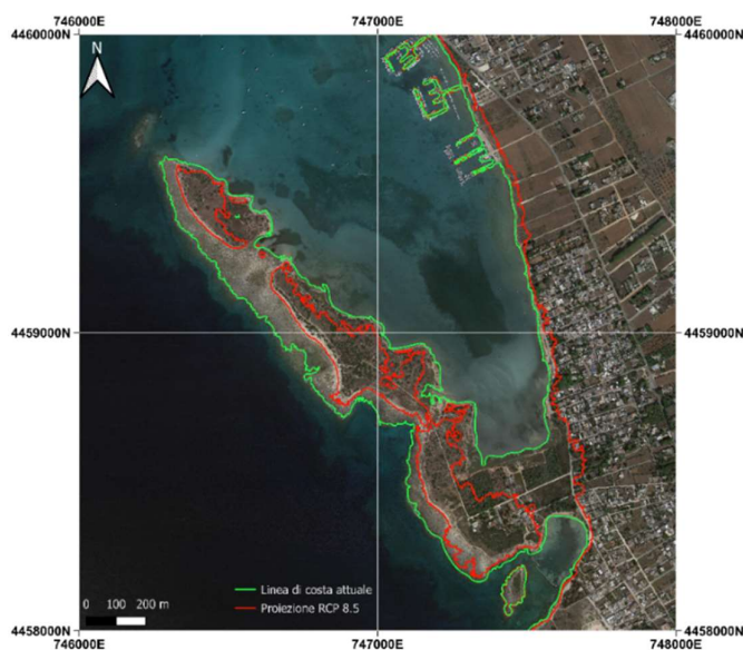
Figura 18. Arretramento della linea di costa Penisola della Strea. Mappa in scala 1:1000.
