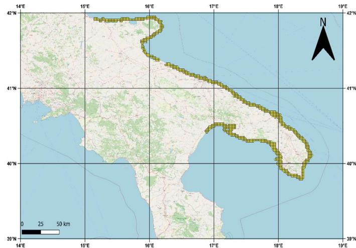
Figura 5. Visualizzazione in Quantum GIS in coordinate equirettangolari del quadro di unione delle circa 800 tavolette il cui mosaico fornisce il DTM dell'intera costa pugliese.
