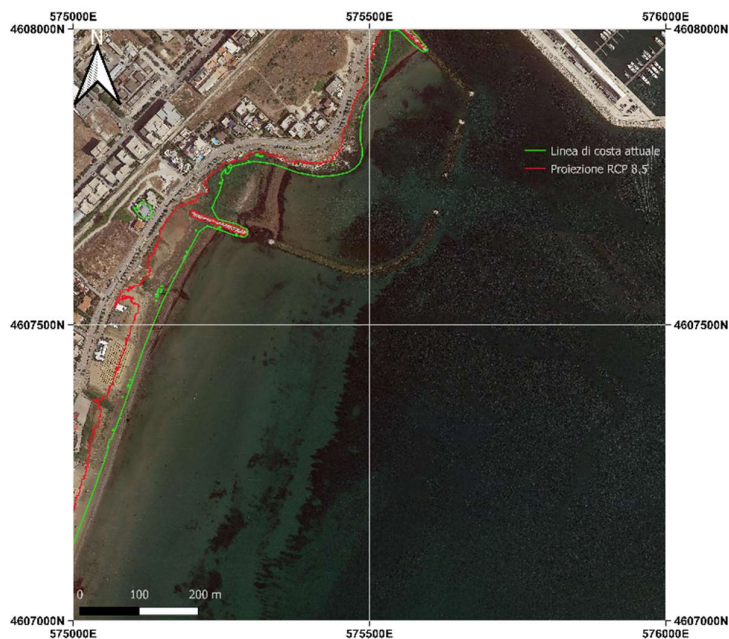
Figura 34. Arretramento della linea di costa in prossimità di Siponto (Manfredonia). Mappa in scala 1:5000.
