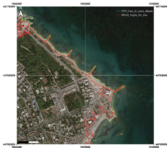
Figura 24. Arretramento della linea di costa in prossimità di San Cataldo (Lecce). Mappa in scala 1:5000.
