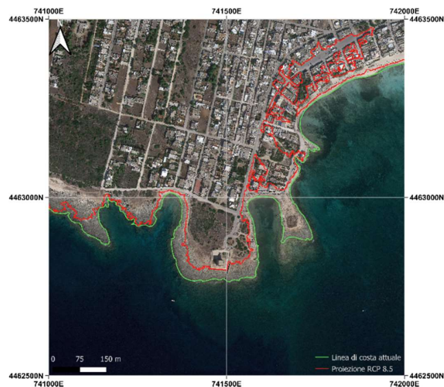
Figura 19. Arretramento della linea di costa frazione Torre Lapillo (Porto Cesareo). Mappa in scala 1:5000.
